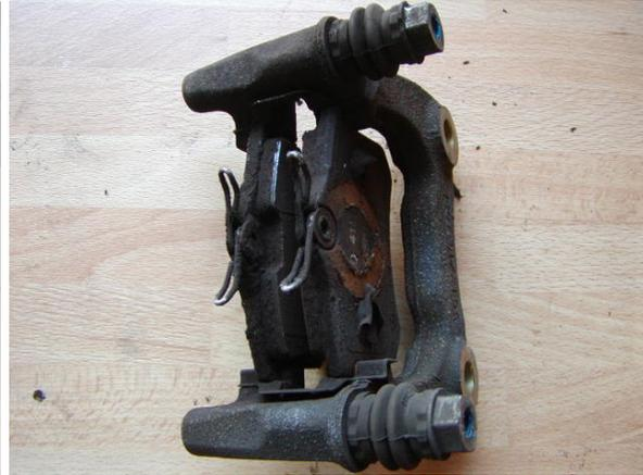
Bild 2 Bremssattel vor der Reinigung
